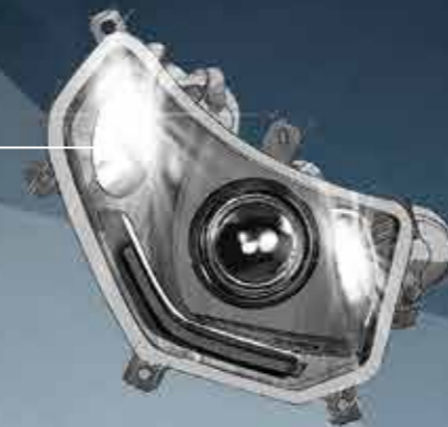
Arbeitslicht (Modul 70 LED)
